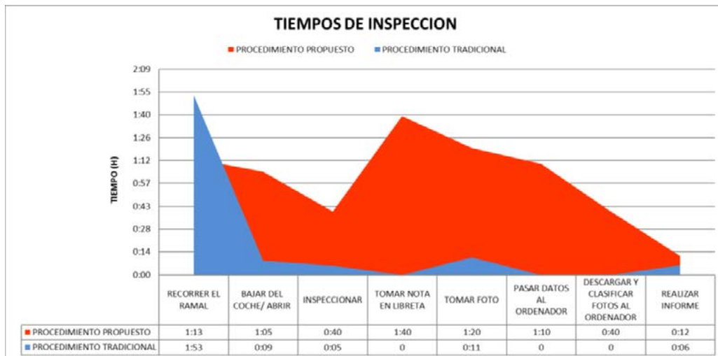
Fig. 8: Tiempos de inspección detallados por tarea individual para los procedimientos tradicionales frente a los propuestos. Se obtuvieron datos para una ruta que incluye 20 instalaciones que duraron unas 8 h.
