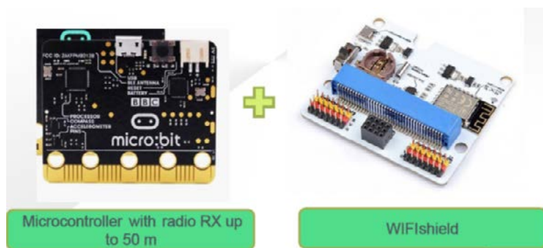
Fig. 5: Componentes principales de la unidad receptora de la estación agrometeorológica DSG.
