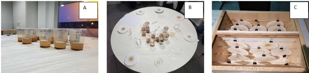
Figura 4. Cromatografía circular del suelo: A. mezcla del suelo seco con NaOH al 1%, B. proceso de impregnado de la muestra en el papel de filtro tratado con Ag NO 3 al 0,5%, y C. caja de cromas
