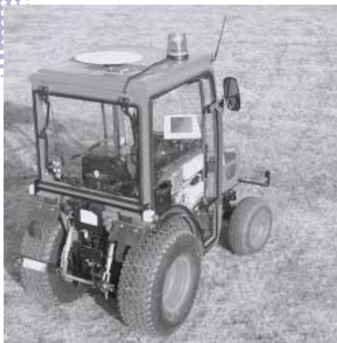
Førerløs og fuldautomatisk traktor, som kan navigere på basis af et digitalt kort over udsåede frø. Foto: Michael Nørremark
