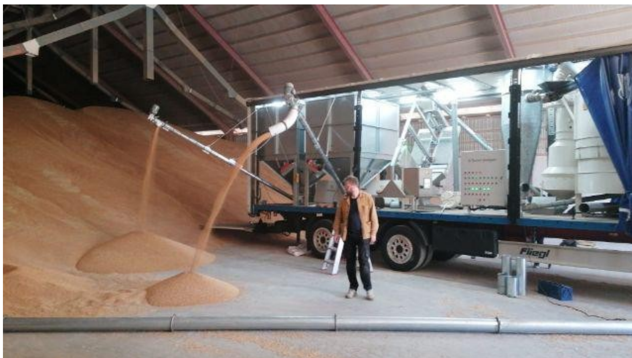
Figur 9: Kvalitetsforbedring af brødkorn ved frasortering af kerner med lavt protein-indhold, lavt faldtal og kerner med mycotoksiner
