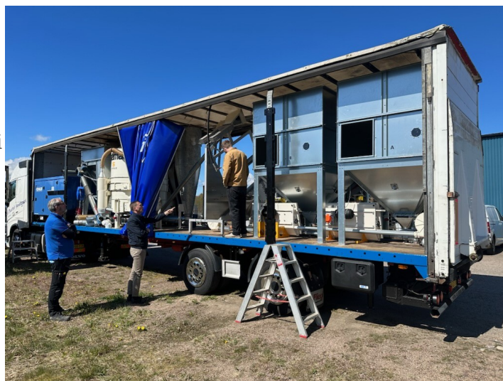
Figur 3: Den første inspektion af verdenssensation i form af en mobil kornfabrik, som kan sortere 4 tons korn i timen i forhold til kernernes protein-indhold.
