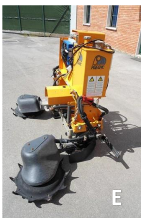
Immagine A: pacciamatura con corteccia, Immagine B: pacciamatura con film di amido di mais, Immagine C: macchina utilizzata per il pirodiserbo, Immagine D: erpice a dischi bilaterale, Immagine E: erpice a dischi rotante, Immagine F-G: spazzolatrice, Immagine H: aratro a dischi o rinalzatore. Immagini A-H: Ewald Lardschneider, Centro di ricerca Laimburg.
