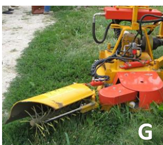
Immagine A: pacciamatura con corteccia, Immagine B: pacciamatura con film di amido di mais, Immagine C: macchina utilizzata per il pirodiserbo, Immagine D: erpice a dischi bilaterale, Immagine E: erpice a dischi rotante, Immagine F-G: spazzolatrice, Immagine H: aratro a dischi o rinalzatore. Immagini A-H: Ewald Lardschneider, Centro di ricerca Laimburg.
