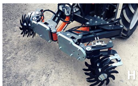
Immagine A: pacciamatura con corteccia, Immagine B: pacciamatura con film di amido di mais, Immagine C: macchina utilizzata per il pirodiserbo, Immagine D: erpice a dischi bilaterale, Immagine E: erpice a dischi rotante, Immagine F-G: spazzolatrice, Immagine H: aratro a dischi o rinalzatore. Immagini A-H: Ewald Lardschneider, Centro di ricerca Laimburg.
