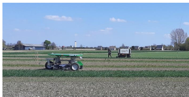
Foto 2. Til den stribebaserede dyrkning anvendes primært autonome enheder i form af Farmdroid FD20 og Agrobot Robotti
