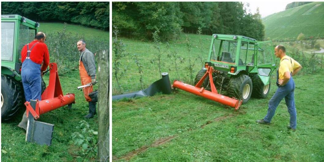
**Abb. 8:** Pflug zum Verlegen der Barrierematerialien. Im linken Bild fehlt noch die drehbar gelagerte Stange zum Aufnehmen der Materialrollen. Durch das Arbeitsgerät konnten das Anlegen des Grabens und das Verlegen der Barrierematerialien in einem Arbeitsschritt verrichtet werden (rechts).
