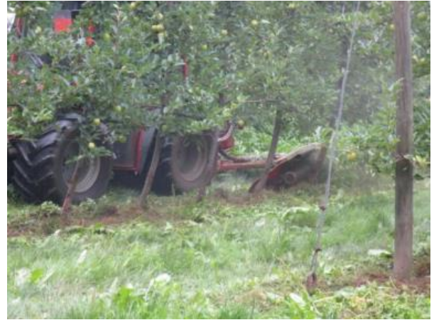
Renholdelse med sideforskudt Ladurner krümles indtil juni. Derefter Ladurner med snører som ses her. Den går ikke i jorden, men fjerner ukrudt over jordoverfladen. Den virker godt i vådt vejr og om efteråret. Foto Hanne Lindhard.
