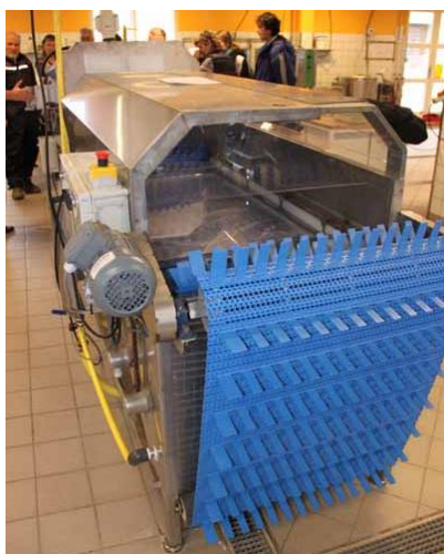
Varmebehandling af frugten inden lagring giver øget holdbarhed og færre problemer med lagersygdomme. Teknikken er dog endnu ikke implementeret helt i praksis. Billedet er af en prototype til varmebehandling af frugt på Aarhus universitet, Food, Årsløv.
