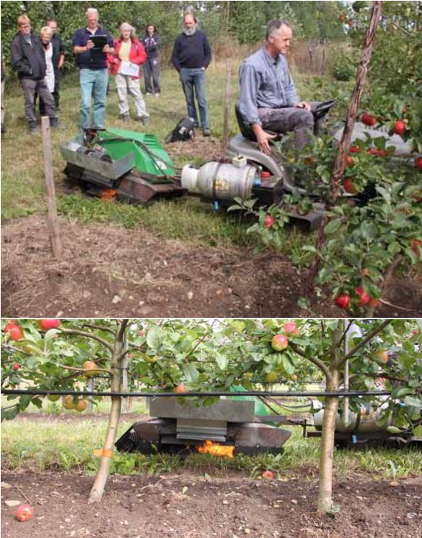
Brænding af ukrudt er også en mulighed. Her er det en prototype fra Envodan til brug i frugttræer.
