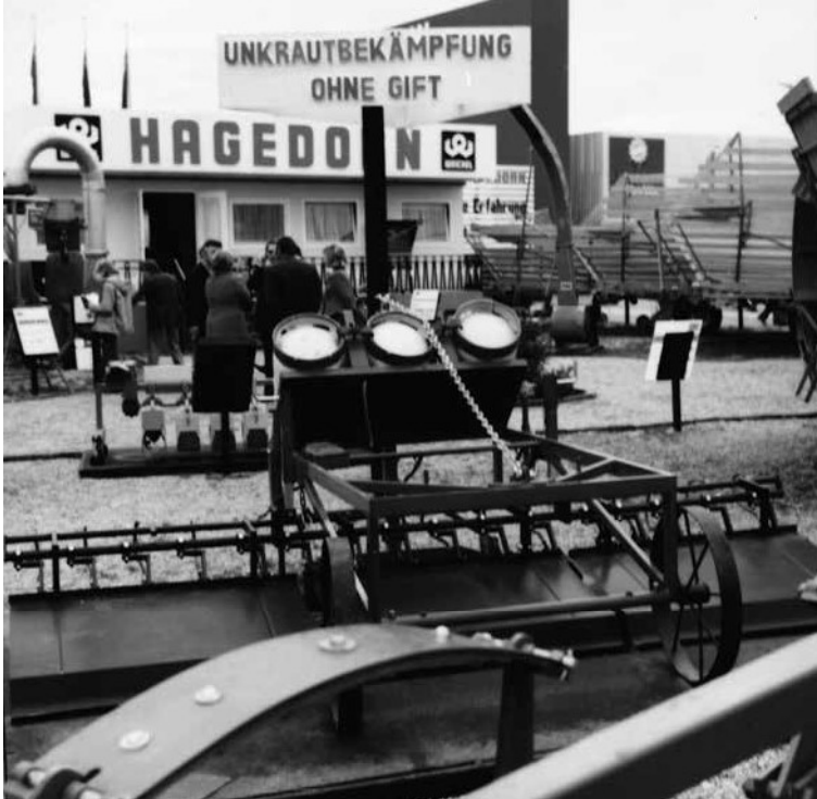
Biofarm entwickelte und vertrieb Ablammgeräte für giftfreie Unkrautregulierung.
