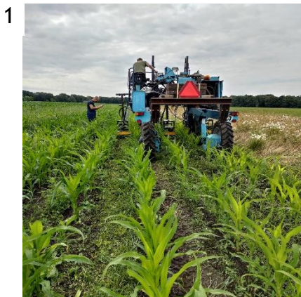
Foto 1: Tussen rij maaimachine maait hier het partnergewas (foto: Johan Specken, WUR). Foto 2: In de rijegmachine in actie (Michel Raaphorst, NMB)
