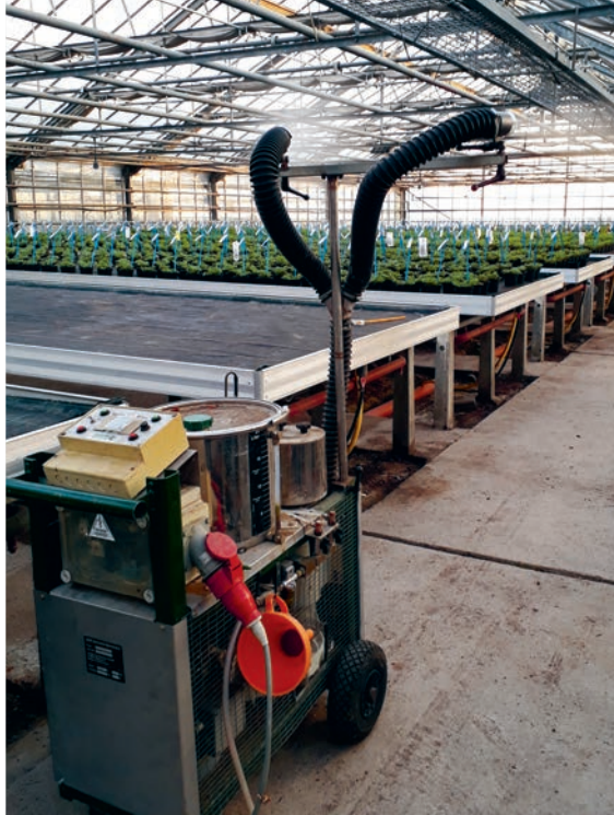
Kaltnebelgerät zur Vernebelung der Aromastoffe
