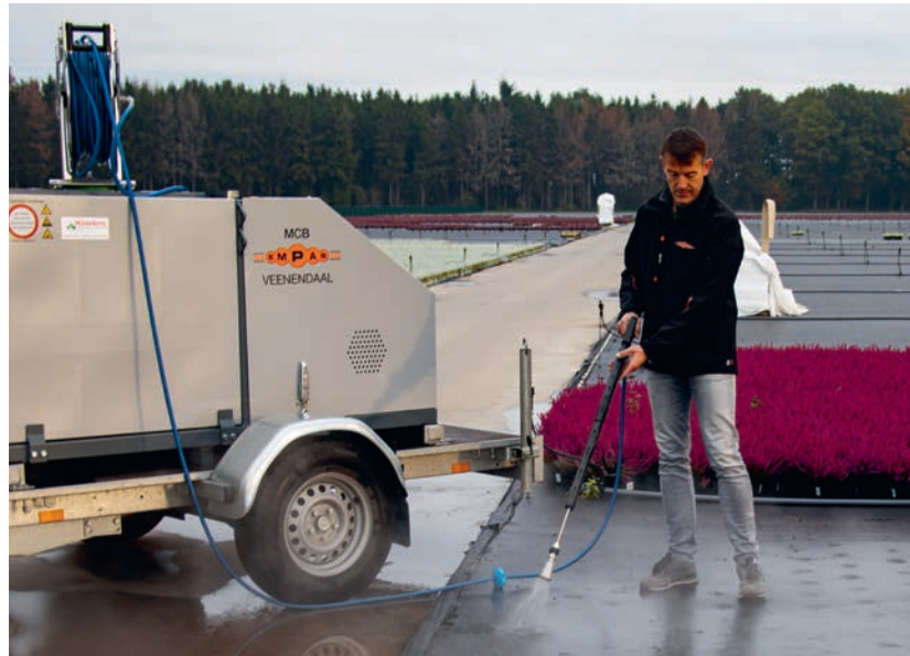
Heißwasseranwendung auf Bändchengewebe zur Unkrautregulierung.
