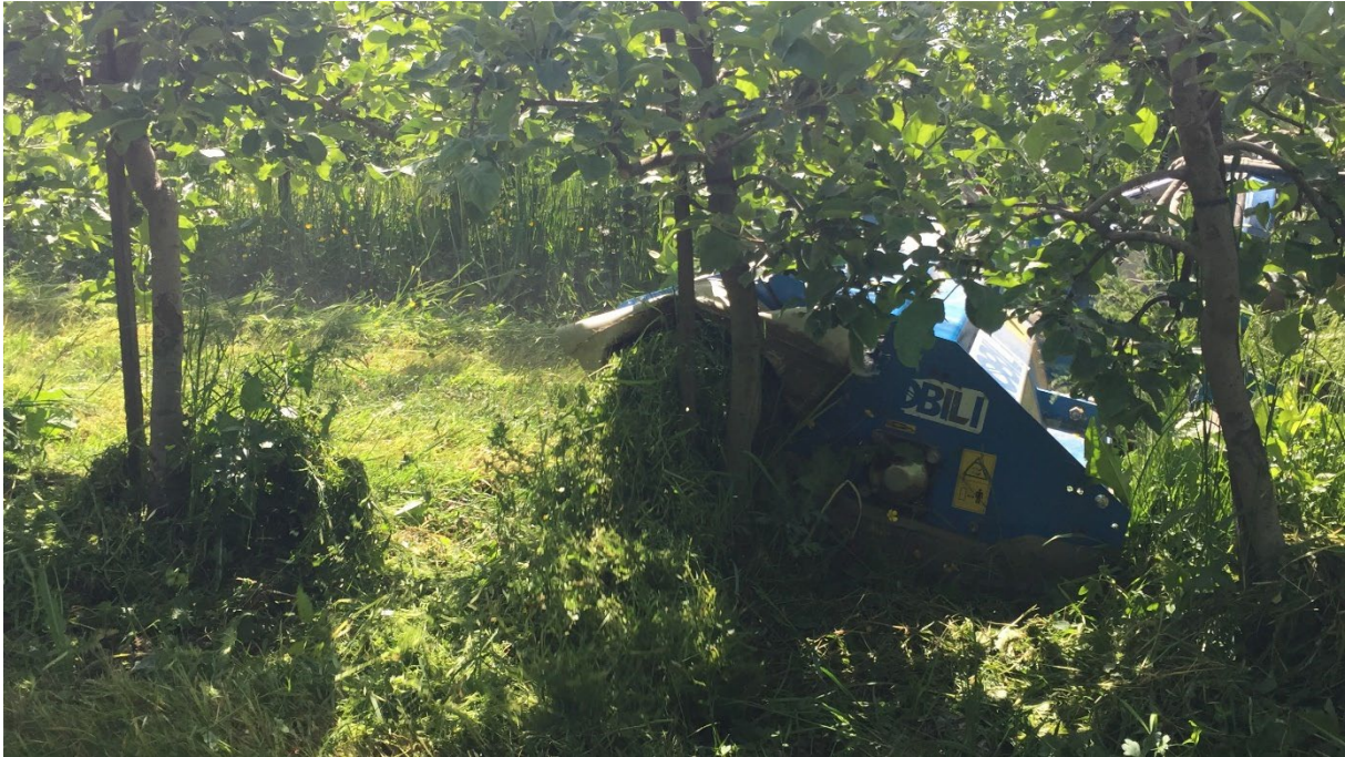
Abbildung 48: Das Mulchgerät mit einseitigem Auswurf im Einsatz.
