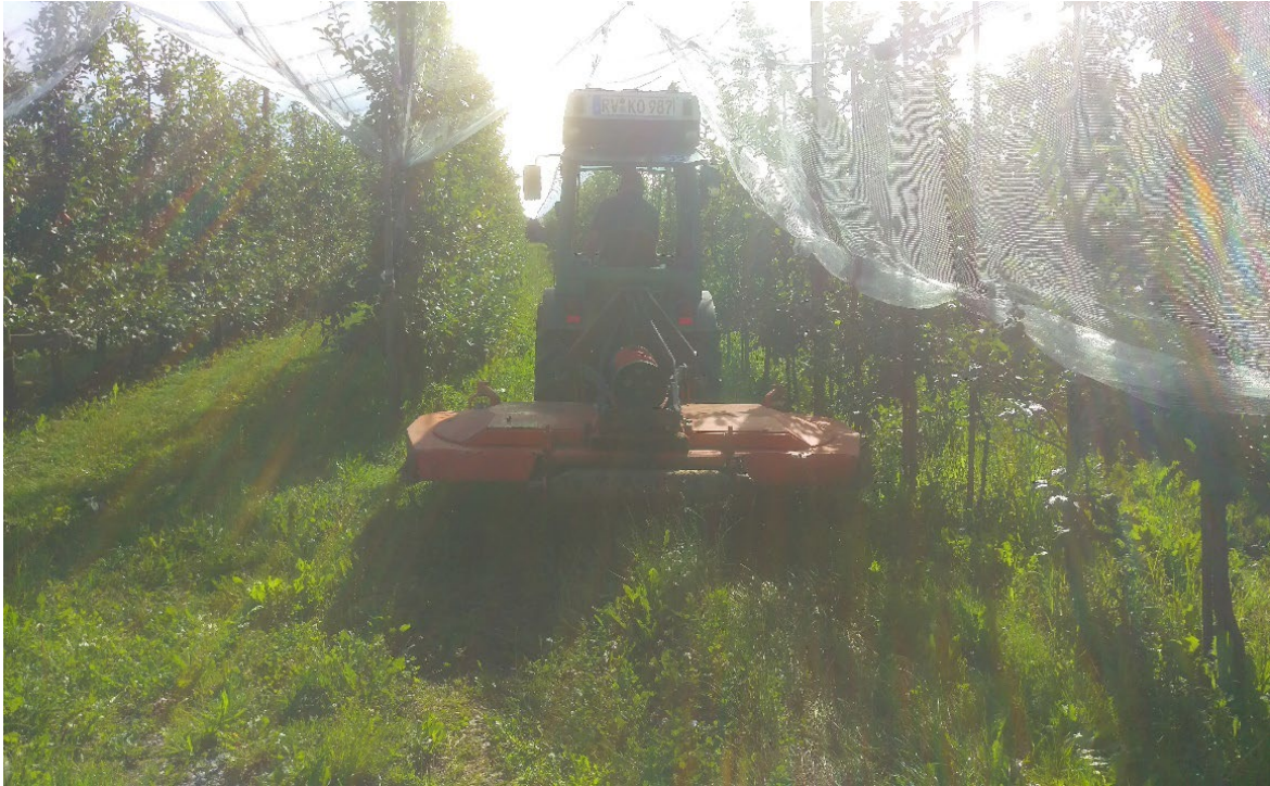
Abbildung 47: Praxisübliches Scheren-Mulchgerät (zweiseitiger Auswurf).
