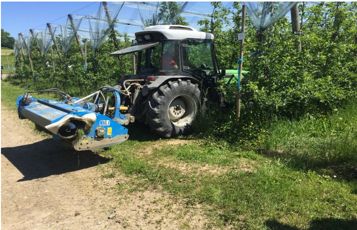
Abbildung 46: Mulchgerät mit seitlicher Auswurf-Schnecke.
