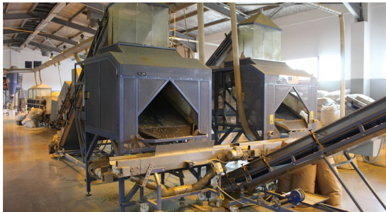
Linija za obradu za uklanjanje stabljika i čišćenje kamilice
