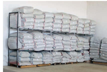
Ove vrećice se čuvaju preblizu zida. To može uzrokovati nakupljanje vlage između zida i vreća.
