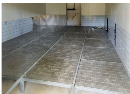
Prazna sušara za kontejner sa ventilisanim podom
