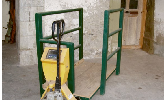
Pour déterminer le poids précis des veaux, une station de pesée a été construite pour le transpalette sur lequel sont menés les veaux
