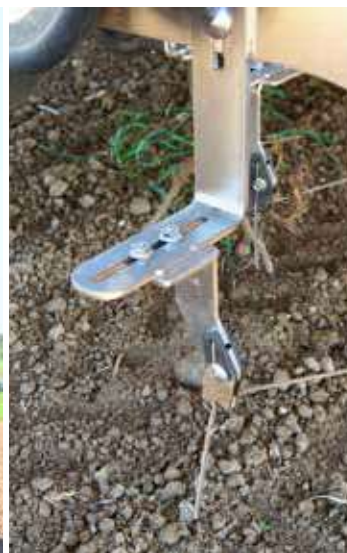
Les fils de sarclage coupent dans la terre les adventices en train de lever.
