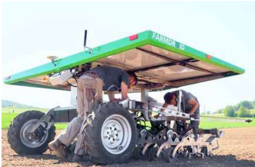
Im Feldversuch war der Betreuungsaufwand anfänglich gross. Mittlerweile leistet der autonome Farmroboter zuverlässig seine Dienste im Acker und spart aufwendige Handarbeit.
