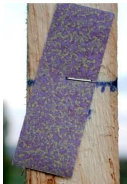
Die Kontrolle des Spritzbildes erfolgt mit Sensitivpapier, verteilt im oberen mittleren und unteren Baumbereich.
