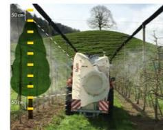
Ein gut eingeworfenes Gerüst ermöglicht einen gleichzeitigen Spritzelzug über die gesamte Baumkrone, von der Baumspitze bis zu den untersten Trieben, von Baummitten und auf die Blattober- und -unterseite.
