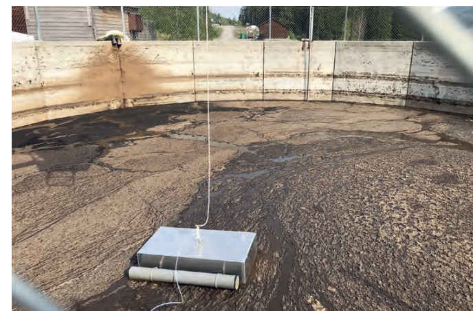
Ved tilforsel av gjødsekk ovenfra dannes det lite skorpe p gjødsla. Gassprøver tas fra boksen ved noen minutters intervall ved hjelp av slangen som er forbundet med boksen. Foto: S. Hansen, NORSØK.
