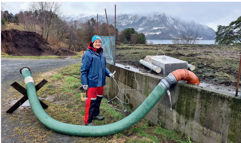
Det er lite gassutslipp i kalde varer. Her tar Martha Ebbesvik gassprøver fra en gjødsekkum. Gassen samles opp i boksen som flyter opp  gjødsla. Foto: P. Haugnes, NORSØK.
