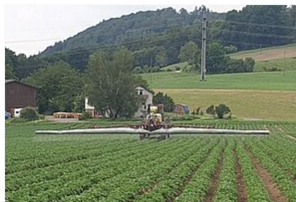
Un pulvérisateur avec assistance d'air aide le nuage de traitement à pénétrer dans toute la masse foliaire de la culture. (Photo: FiBL, Tobias Gelencsér)
