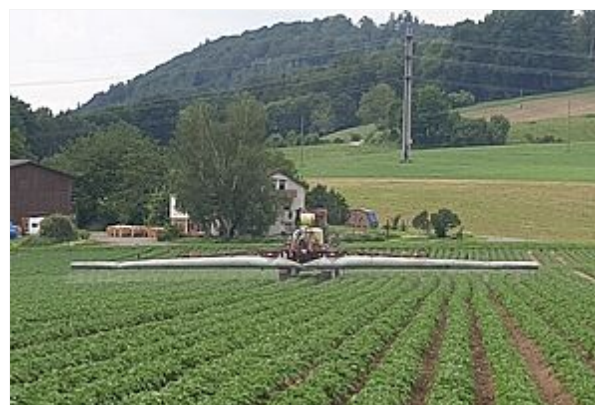
Eine Feldspritze mit Luftunterstützung hilft den Kartoffelbestand mit dem Sprühnebel zu durchdringen. (Foto: FiBL, Tobias Gelencsér)
