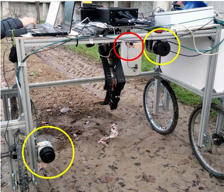
Figura 2. Localización del brazo robotizado y de los sistemas sensóricos (cámara multispectral, rojo) y LiDARs (amarillo).
