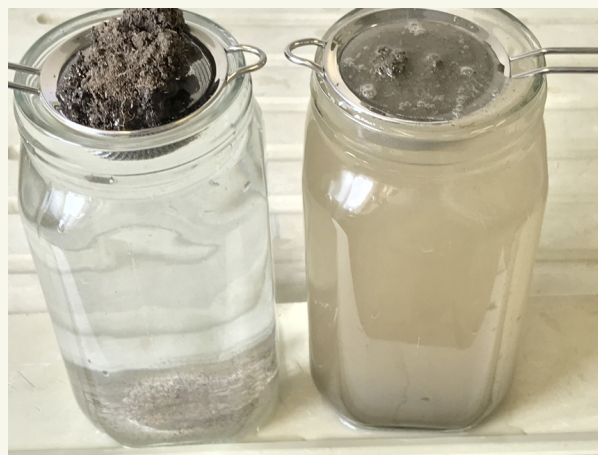
Joonis 1: mullaosakeste stabiilsus kahes liivsavi mullas, millest ühe MOA sisaldus on 7% (vasakul) ja teise 2% (paremal).
