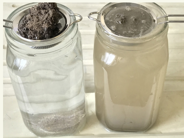
Slika 1: Stabilnost zemljišnih agregata dve peskovite ilovače sa 7% organske materije zemljišta (levo) i 2% organske materije zemljišta (desno).
