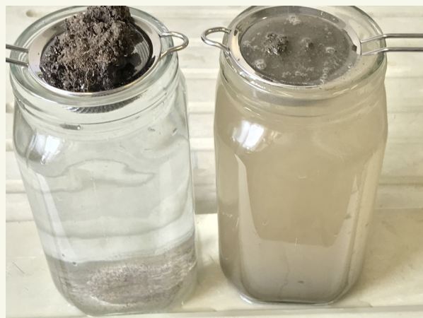
Obr. 1: Stabilita pôdnych agregátov dvoch pieso nato-hlinitých pôd so 7 % SOM (avá strana) a 2 % SOM (pravá strana).
