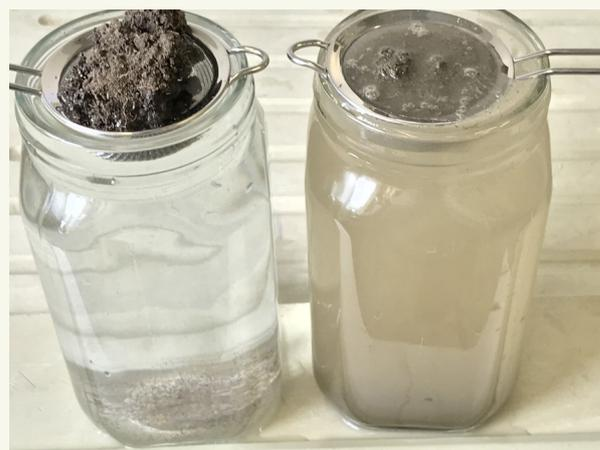
Imagem 1: Estabilidade dos agregados do solo de dois solos arenosos com 7% MOS (lado esquerdo) e 2% MOS (lado direito).
