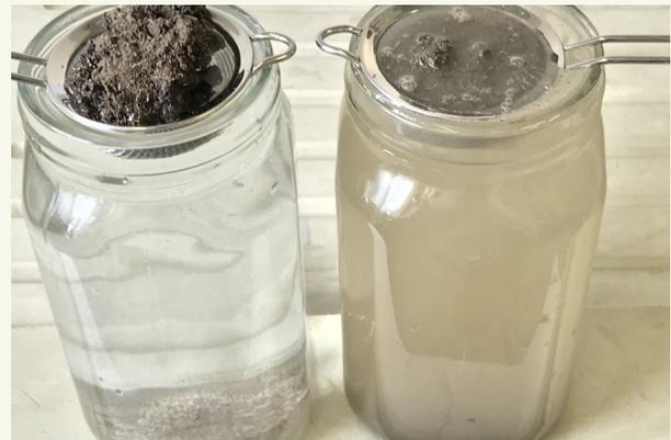
Fig. 1: Stabilità degli aggregati del terreno in due suoli argilloso sabbiosi con 7% SOM (lato sinistro) e 2% SOM (lato destro).
