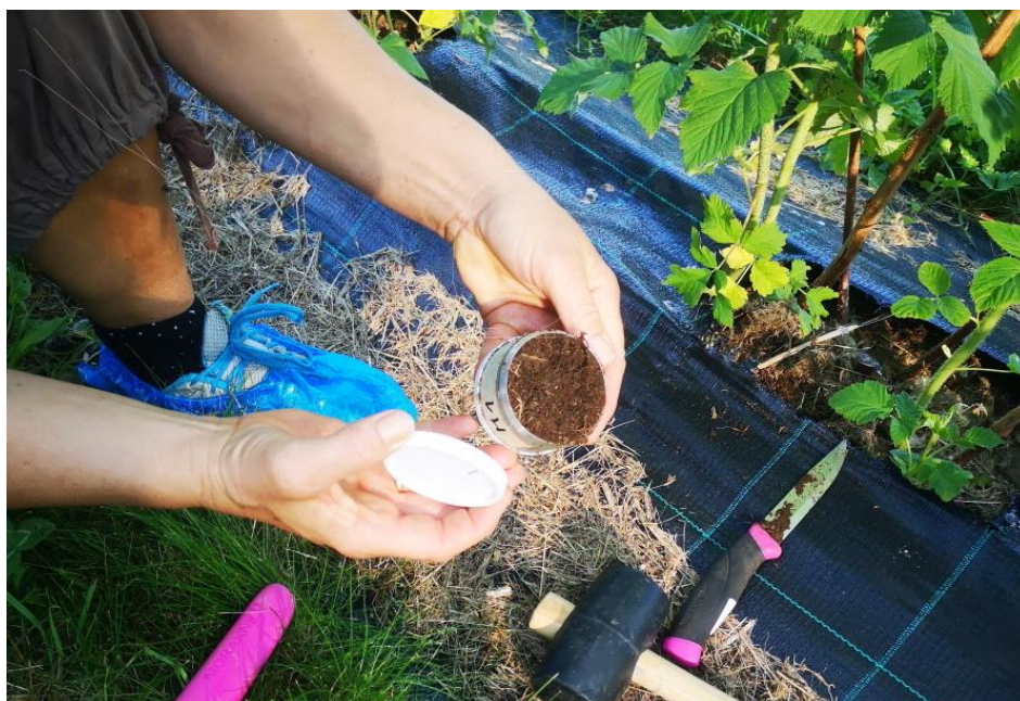
Bilde 8. Metallsylinder med jord for bestemmelse av tetthet av midd og spretthaler (Foto: A. Wibe).
