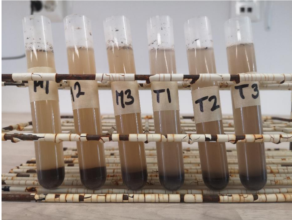
Bilde 4. Prøverør med jordprøver løst i vann med reaktivt pulver (Foto: A. Wibe)
