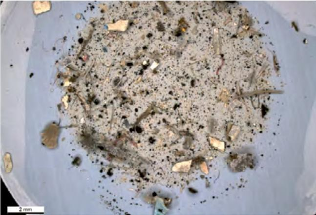
In einer Bodenprobe, die entlang einer Straße extrahiert wurde, sind neben anderen Teilchen deutlich Mikroplastikpartikel von Autoreifen (schwarz) zu erkennen.
