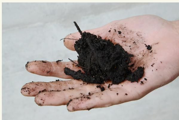
Fig. 3: Prueba de contenido de humedad: Compost con humedad adecuada
