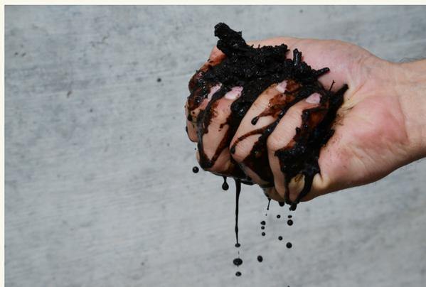
Fig. 4: Prueba de contenido de humedad: Compost demasiado húmedo.
