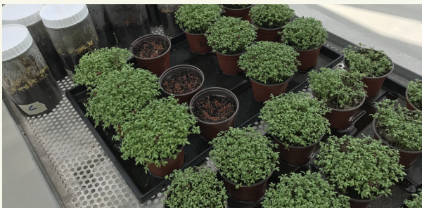
Abb. 1: Offener und geschlossener Kressetest, 7 Tage nach Aussaat, fertig zur Interpretation.
