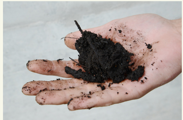
Abb. 3: Fausttest: Der Kompost hat den richtigen Feuchtigkeitsgehalt.
