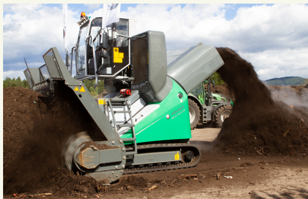
Fig. 2: Volteadora de compost comercial autopropulsada.
