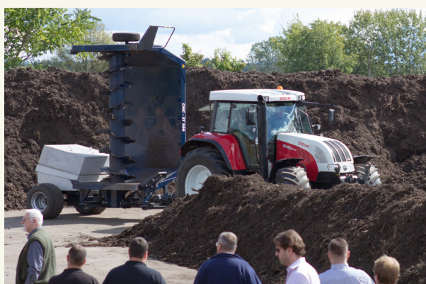
Fig. 1: Volteadora de compost accionada por un tractor con toma de fuerza.
