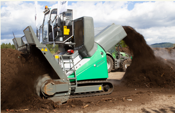
Abb. 2: Selbstfahrender, gewerblicher Kompostwender.
