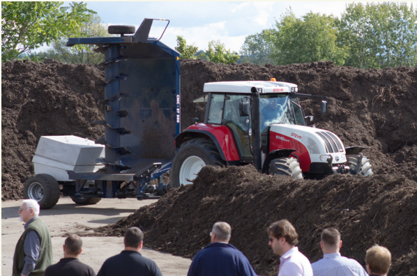
Abb. 1: Mit Traktor und Zapfwelle angetriebener Kompostwender.
