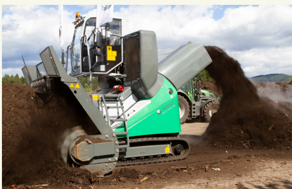
Obr. 2: Samohybný obraceč/homogenizátor kompostu
