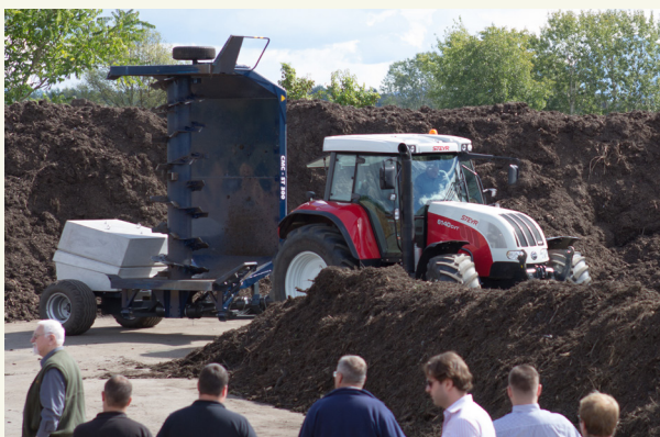
Obr. 1: Traktorem/hřídělí poháněný obraceč kompostu
