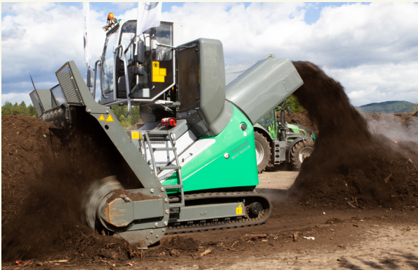
Slika 2: Samohodni komercijalni prevrtač komposta
