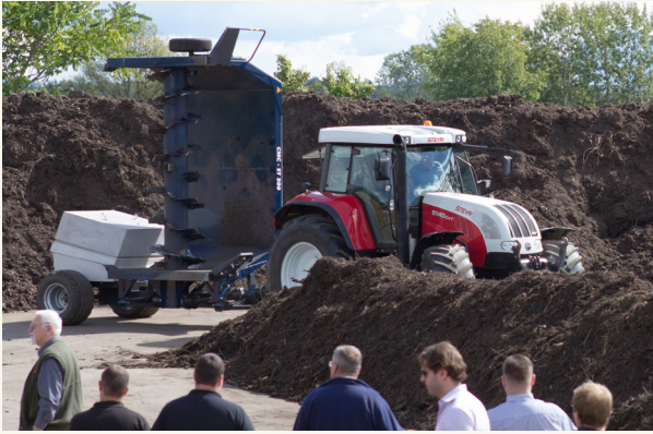
Fig. 1: Traktorom/ hriadelom poháňaný obracač kompostu
