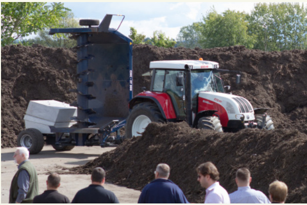
Imagem 1: Revirador de composto acionado pela TDF (tomada de força).
