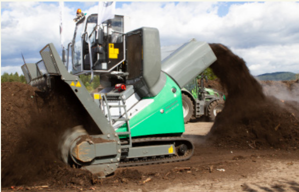
Imagem 2: Revirador de composto comercial e automatiz.
