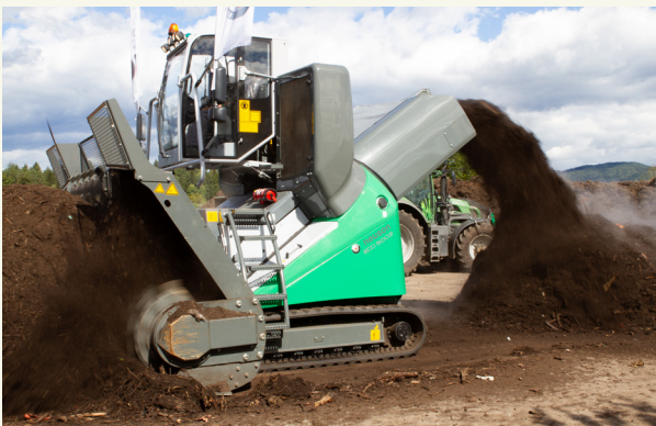
Obraz 2. Samobieżny, profesjonalny mikser do przerzucania i mieszania kompostu
