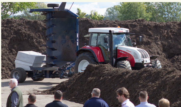
Fig. 1: trekker/PTO (aftakkas) aangedreven compostkeeder.
