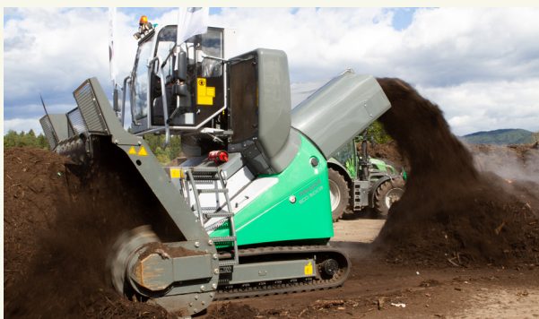
Fig. 2: Zelfrijdende, commerciële compostkeeder.
