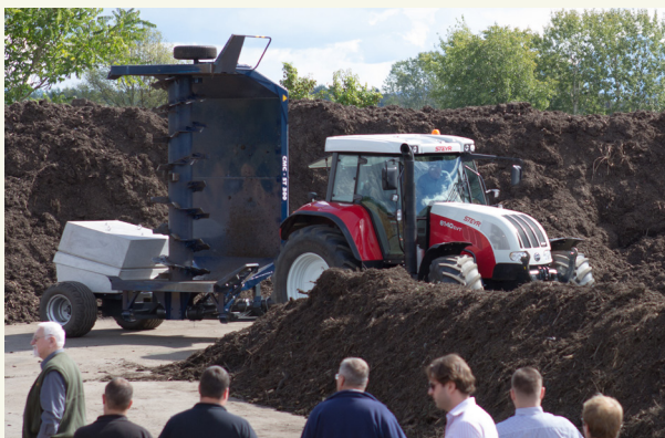
1. attēls. Komposta virpotājs, ko darbina traktors un jūgvārpsta.
