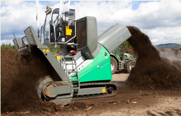
Fig. 2: Semovente, per il rimescolamento del compost commerciale.
