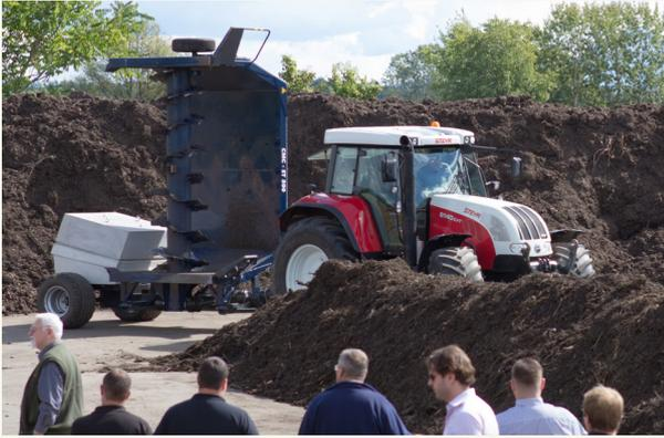
Fig. 1: Trattore / PTO (presa di forza) con attrezzatura trainata per rimescolamento del compost.
