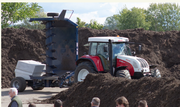
1. ábra: Traktorral vontatott komposztforgató.
