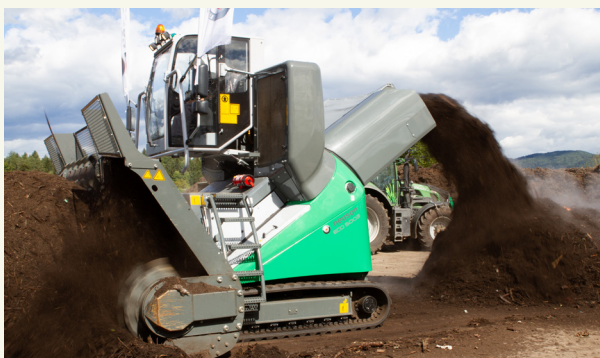
2. ábra: Önjáró, kereskedelmi forgalomban elérhető komposztforgató.
