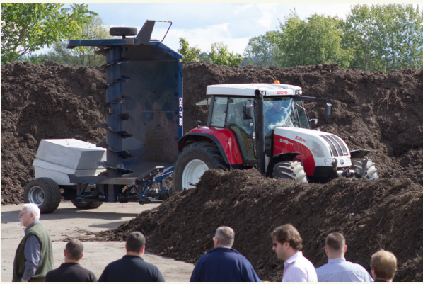
Figure 1: Retourneur de compost entraîné par la prise de force d'un tracteur.
