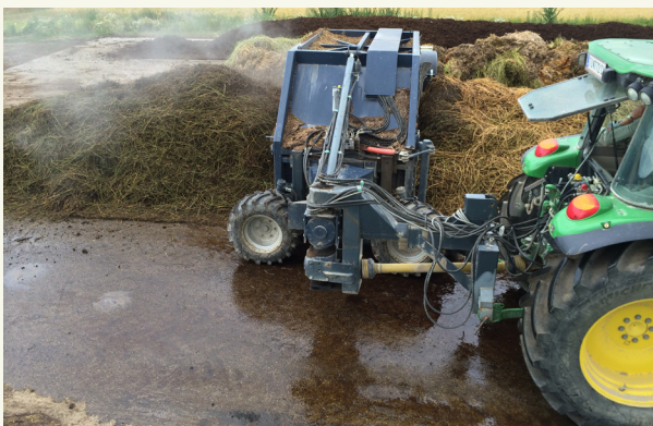
Joonis 1: Termofiilse komposti tootmiseks vajalike ressursside homogeniseerimine komposti pöörajaga
