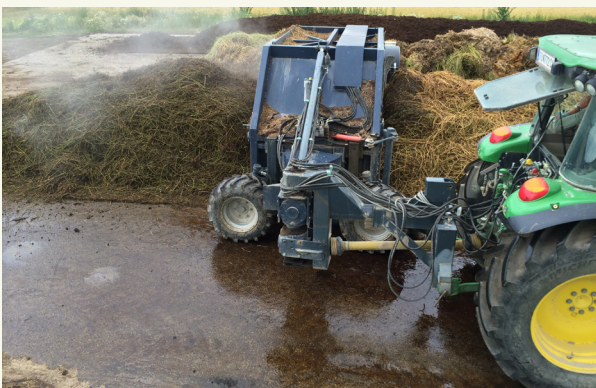
Billede 1: Homogenisering af komposteringsmateriale til termofil kompostering med en kompostvender
