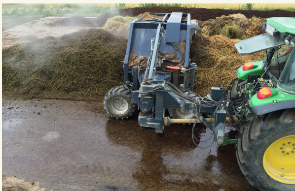
снимка 1: Хомогенизиращи ресурси за производство на термофилен компост с компостен обръщач
