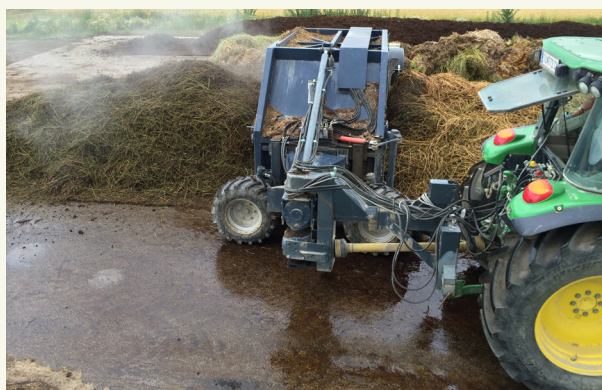
Bild 1: Homogenisering av resurser för termofil kompostproduktion med en kompostvändare
