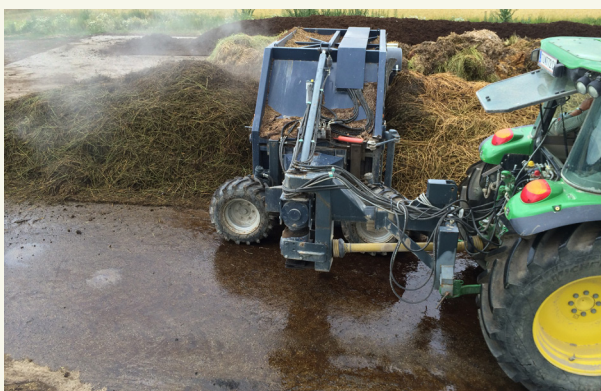
Slika 1: Homogenizacija surovin za proizvodnjo termofilnega komposta s pomočjo obračalnika komposta.
