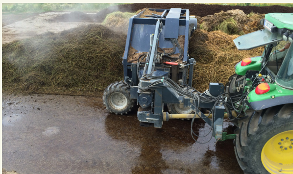
Obr. 1: Homogenizačné nástroje pre výrobu termofilného kompostu s obracačom kompostu
