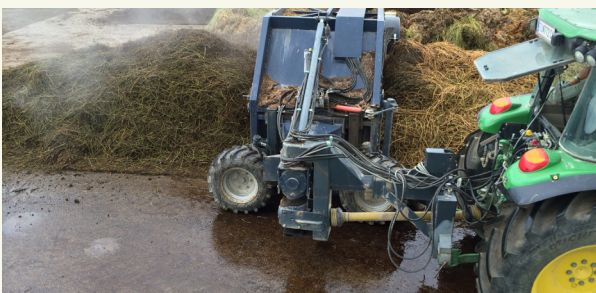
Fig. 1: Gelijktijdig vermengen van grondstoffen voor microbieel verhitte compostproductie met een compostkantelaar
