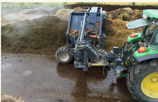
Fig. 1: Omogeneizzazione delle materie prime per la produzione di compost termofilo con apposito miscelatore.
